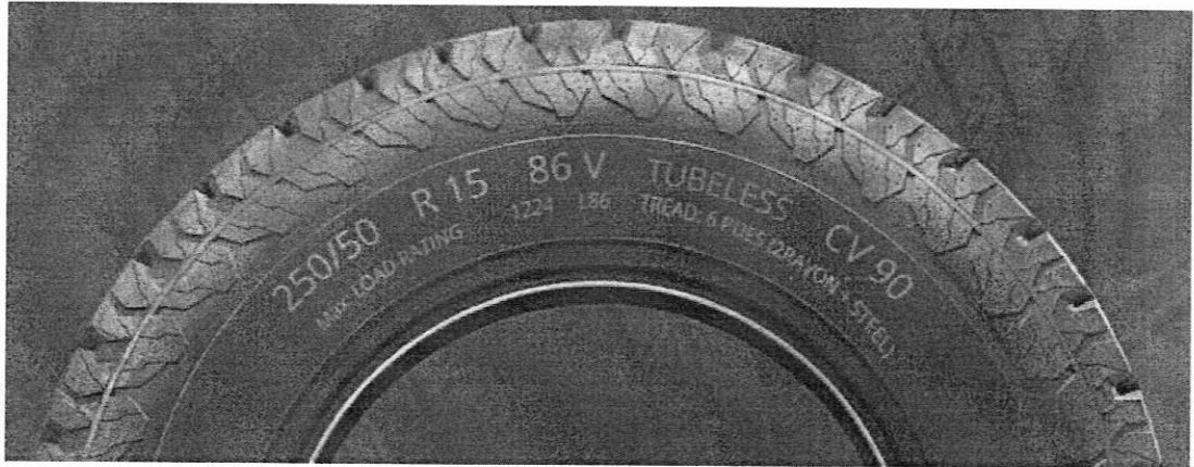
Figura 3 – Exemplificação de OUTROS FATORES (item 4) referente às gravações laterais nos pneus.
